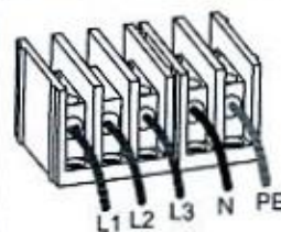
5.9 Cabo CA conectado ao terminal
